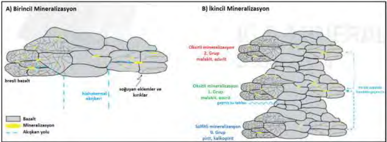
Şekil 12: Çorum'daki mineralizasyon prosesinin şematik modeli. A) Birincil mineralizasyon, lavın deniz tabanında birikmesinden sonra zuhur etmiştir. Hidrotermal akışkanlar, bazalttaki kanallar (breş veya soğuyan kırıklar ve eklemler) aracılığıyla taşınarak Cu bakımından zengin sülfütlü çökeltiler. B) İkincil mineralizasyon, 'yakın zamanda gerçekleşen' bozunmayla zuhur etmiştir. Cu bakımından zengin akışkanlar, kayaç sütununun tamamına Cu taşır. Su tablasının üzerinde Cu, oksitlenmiş bir ortamda oksit veya karbonat mineralleri olarak çökelmiştir; su tablasının altında ise Cu, indirgeyici bir ortamda sülfid mineralleri olarak çökelmiştir.
