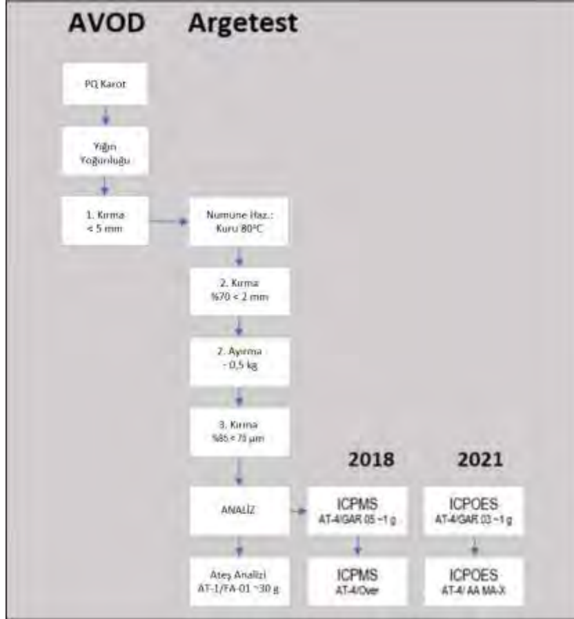
Şekil 19: 2018 sondaj programına ilişkin numune hazırlama ve analiz prosesi (soldadır – 2021 sondaj programı ise sağdadır)
