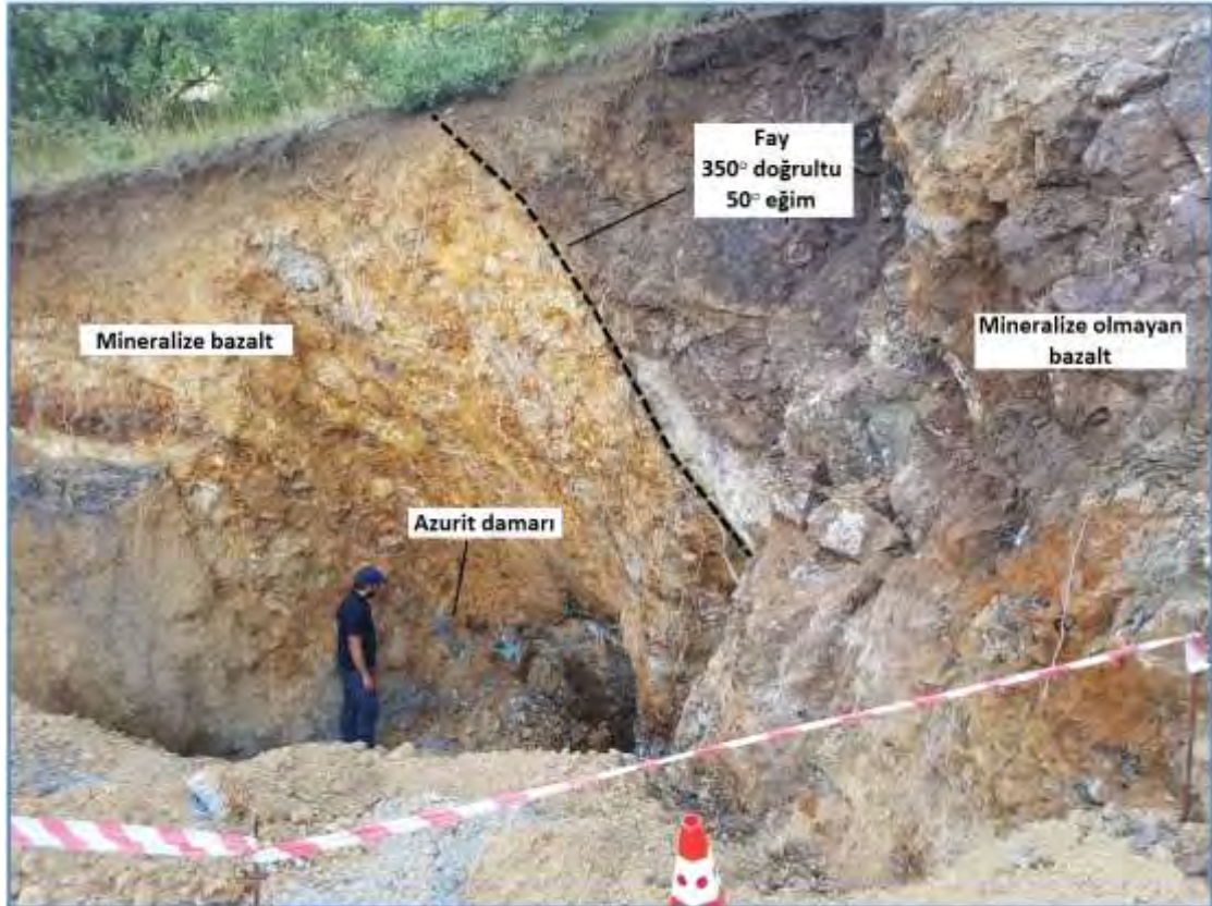
Şekil 14: Kuzeye bakan B Sahası. Fotoğraf, azurit damarlarının ve mineralizasyon sonrası faylanmanın olduğu mineralize bazaltı gösteriyor.
