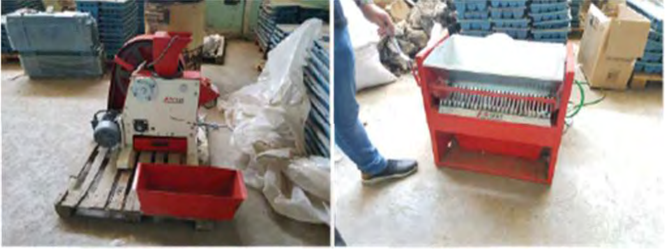
Şekil 21: AVOD tarafından kullanılan birinci ayırma ekipmanı: çeneli kırıcı (solda) ile agrega ayırıcı (sağda)
